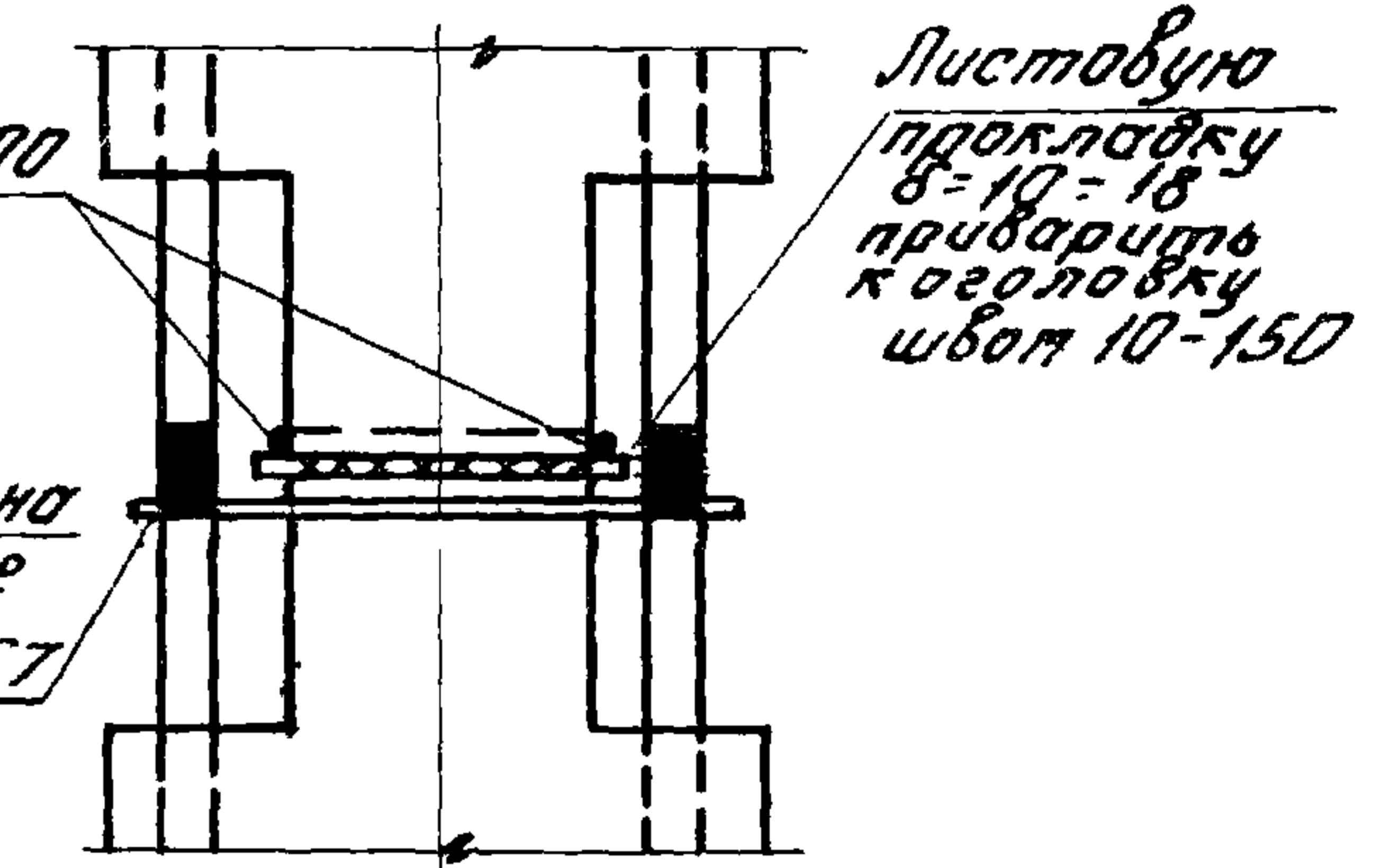
Вариант стыка при зазоре между колоннами < 20мм
